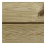
Pour les bois séchés naturellement il peut y avoir des exsudations de résine si l'ouvrage est exposé à la chaleur. Le séchage artificiel de l'épicéa au dessus de 70°C permet d'éviter ce problème, ainsi que l'étuvage ou la thermostabilisation
