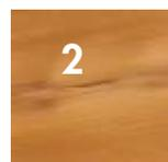
Elles se présentent comme des fentes de surfaces étroites orientées suivant la longueur de la lame. Elles apparaissent principalement lors du séchage ou par temps sec. Elles se referment partiellement en période humide ou pluvieuse.
