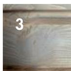
Singularité révélée lors de l'usinage, il peut s'assimiler à des décollements de fibres à proximité des nœuds
